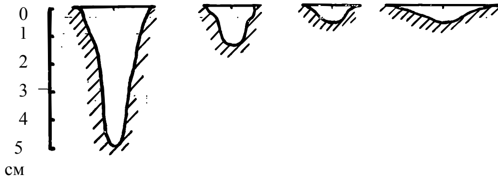
Рис. 3. Форма воронок в различных материалах: 1 – песчано-цементная смесь; 2 – мрамор Коелга; 3 – гранит Курдай; 4 - порфирит Акбастау
