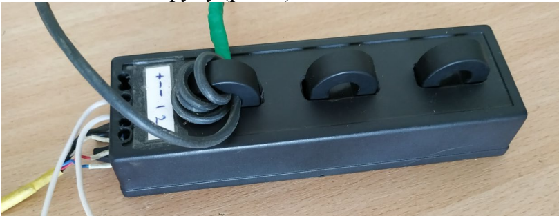
Рисунок 4 – Зовнішній вигляд датчика струму, що використаний у дослідженнях
