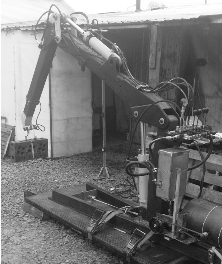
Рисунок 1 – Розроблена експериментальна установка крана-маніпулятора з гідравлічним приводом
