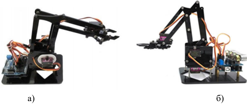
Рисунок - 3. Маніпулятор 4DOF DIY MiniArm
