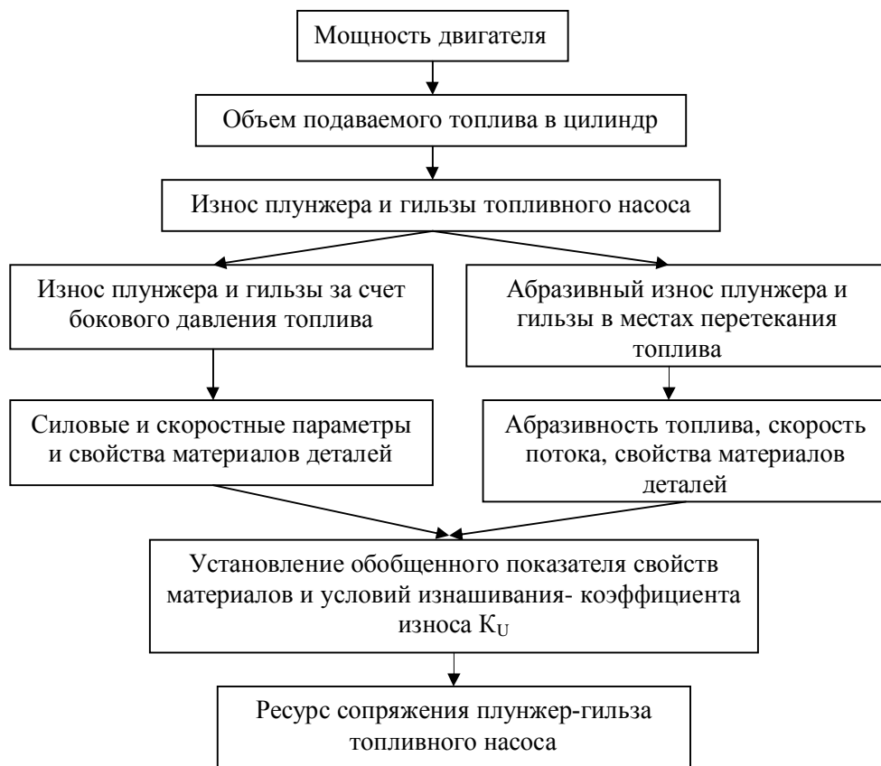
Рис. 1. Схема определения ресурса плунжерных пар топливного насоса.
