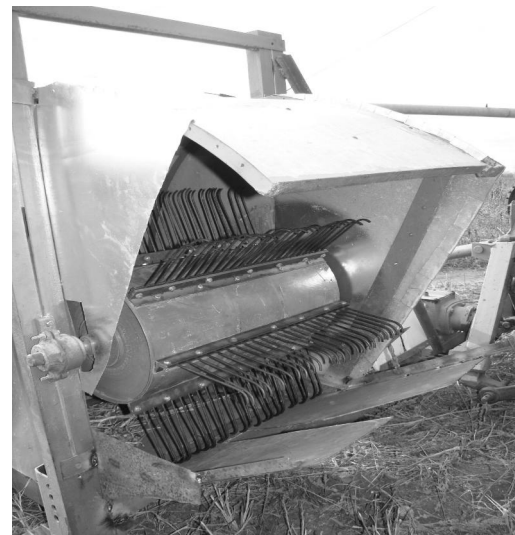
Рис. 6. Циліндричний робочий орган з пружними гребінками
