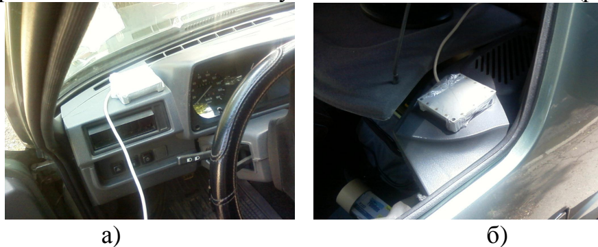
Рис. 3. Установка акселерометрів на автомобілі в передній (а) і задній (б) частині автомобіля
