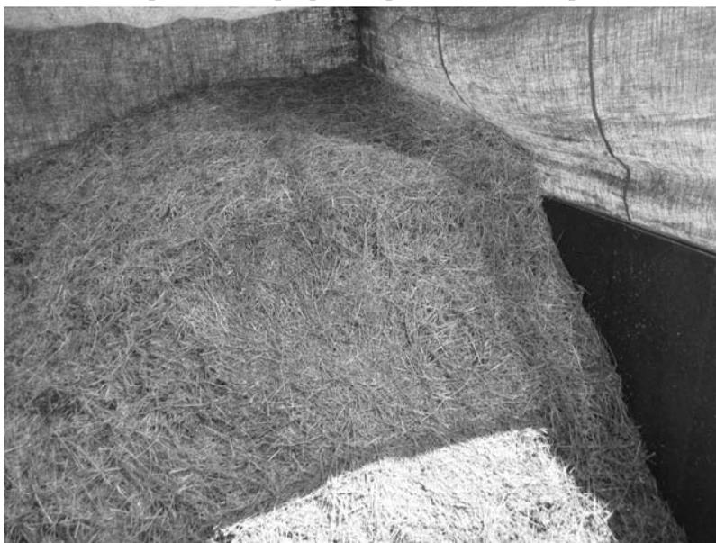
**Рис. 3. Начало заполнения задней части контейнера с тентом массой при горизонтальном расположении козырька выгрузного трубопровода.**
