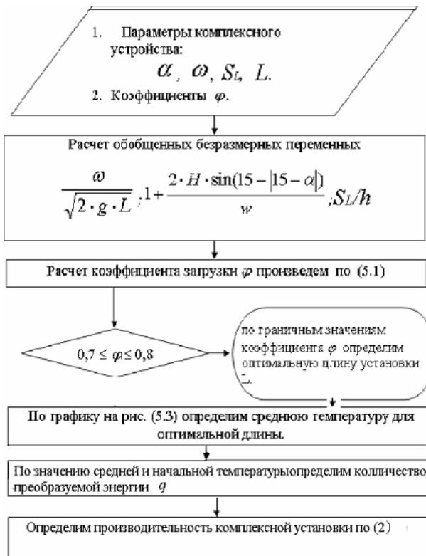
**Рис. 2. Алгоритм определения производительности комплексной установки.**
