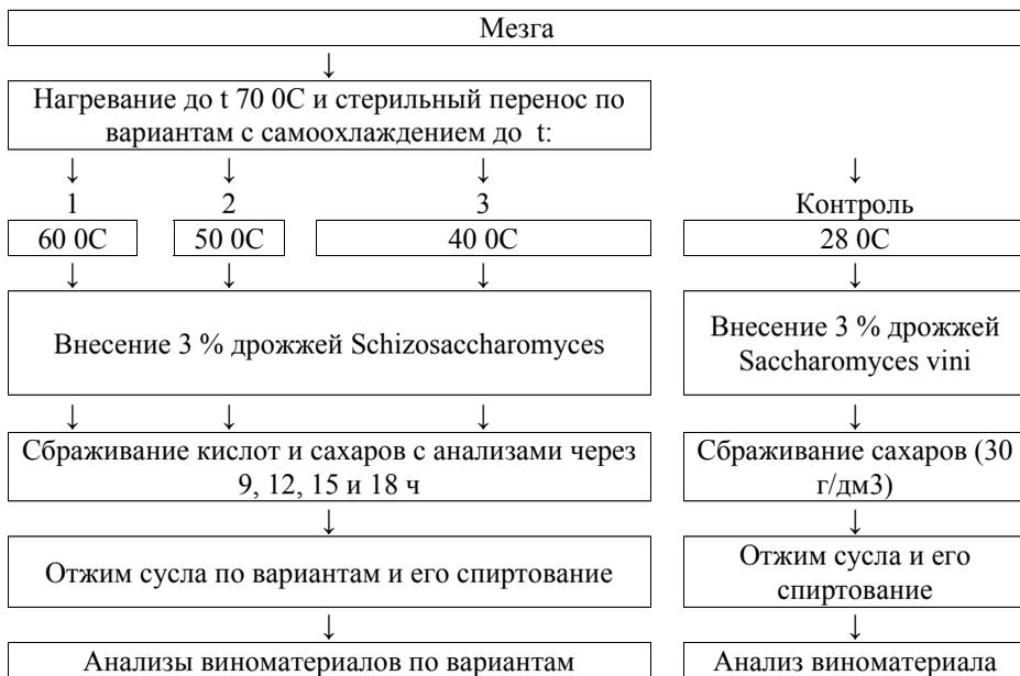
**Рис. 1 – Схема постановки эксперимента**
