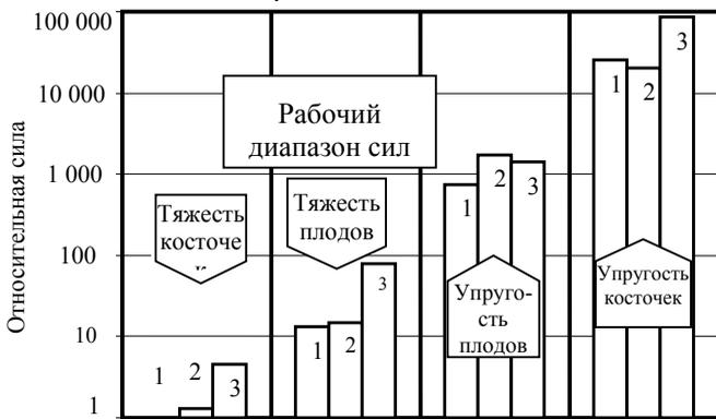
Рис. 2. Диаграмма относительных сил, действующих на плоды и косточки в рабочей зоне дробилки при переработке плодов: 1 – сливы; 2 – абрикоса; 3 – персика
