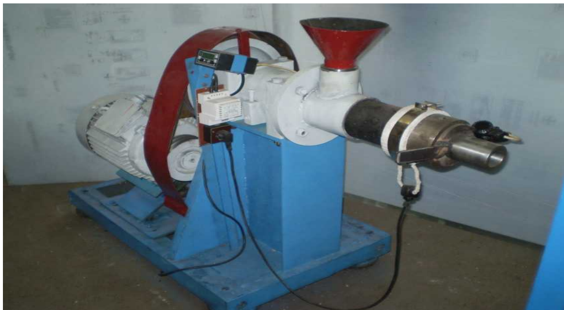
Рис. 2. Загальний вигляд брикетувальника
