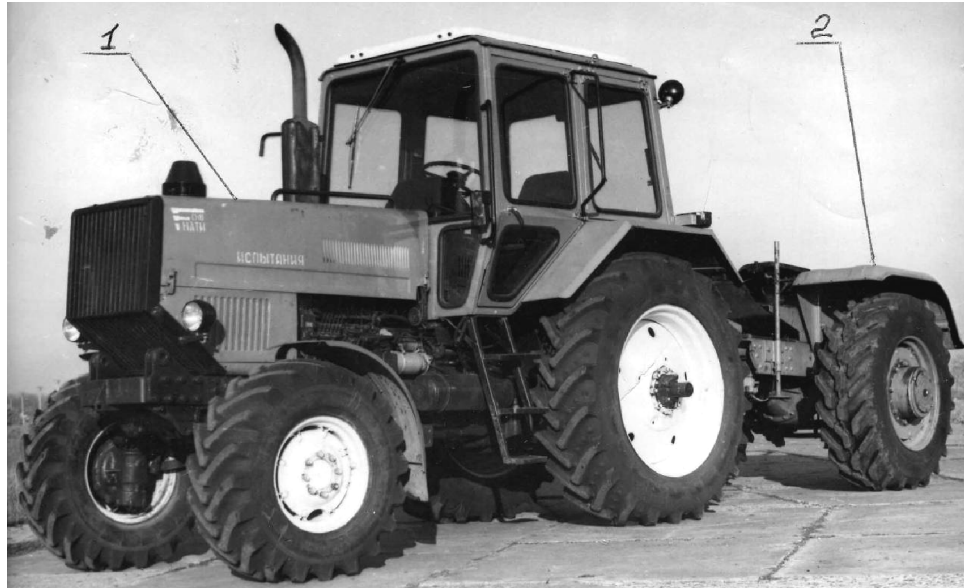
Рис. 2. Загальний вигляд МЕЗ-200 з ТТМ: 1- енергетичний модуль(ЕМ); 2 – транспортно-технологічний модуль (ТТМ). Результати випробувань МЕЗ з ТТМ на рис 3,4,5.
