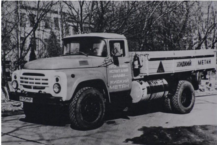
Рис. Є. 1 Автомобіль з вакуумним баком для використання рідкого метану в якості моторного палива
