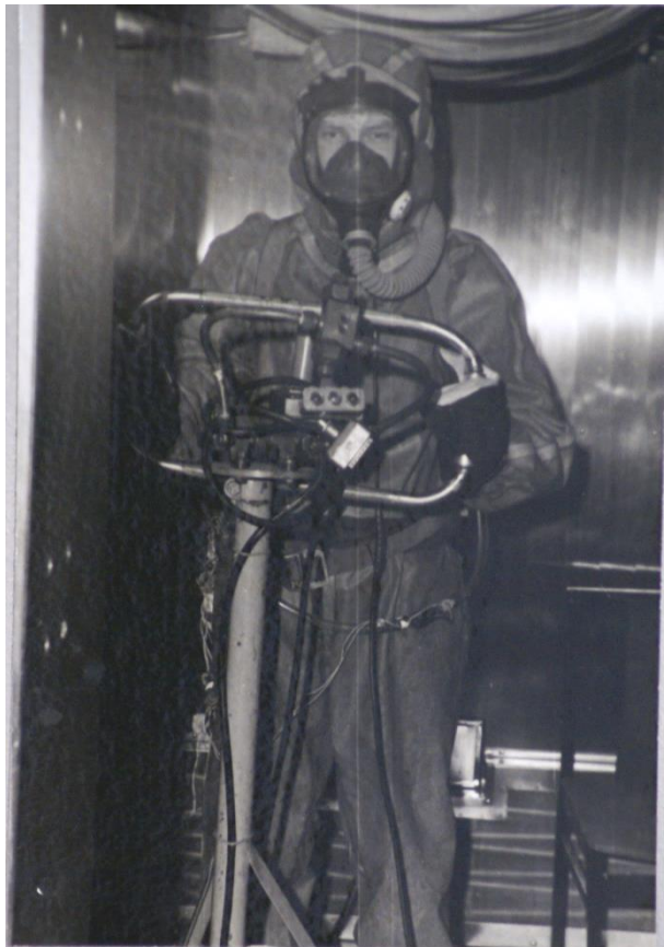
Рис. Є. 16 На випробуванні досвідченого зразка автономної кріогенної системи життєзабезпечення в кліматичній камері Інституту біофізики МОЗ СРСР
