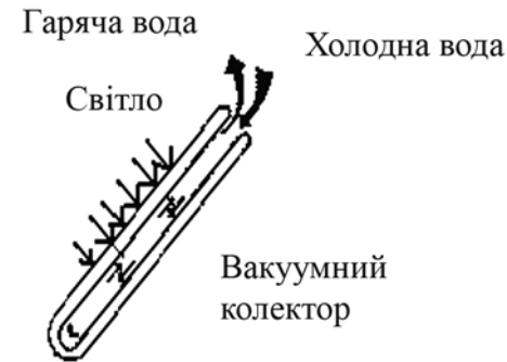
Рис. 13.13. Вакуумний колектор з прямою теплопередачею воді
