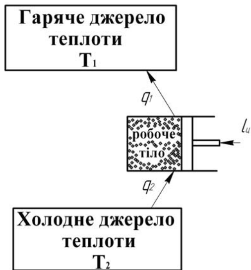
Рис. 3.7. Термодинамічна схема холодильної машини
