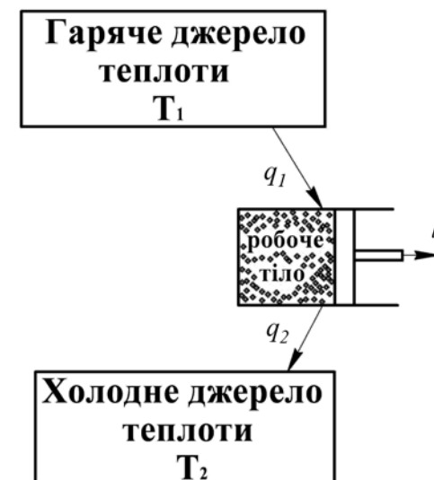
Рис. 3.2. Термодинамічна схема теплового двигуна
