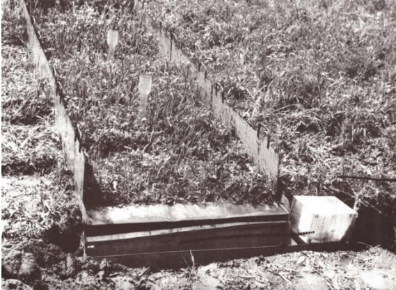
Рис. 1. Вид стокооблікового майданчика при штучному дощуванні
