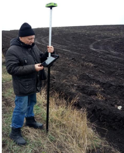
Рис. 5. Встановлення меж сівозмінних масивів при розробленні Проекту землеустрою щодо еколого-економічного обґрунтування сівозмін
